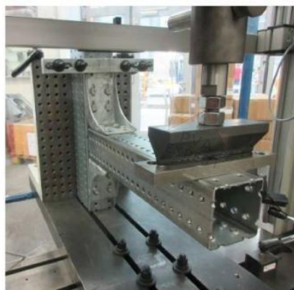
Рисунок И.12 – Примеры испытаний на сдвиг ( а ) и на изгиб ( б )
