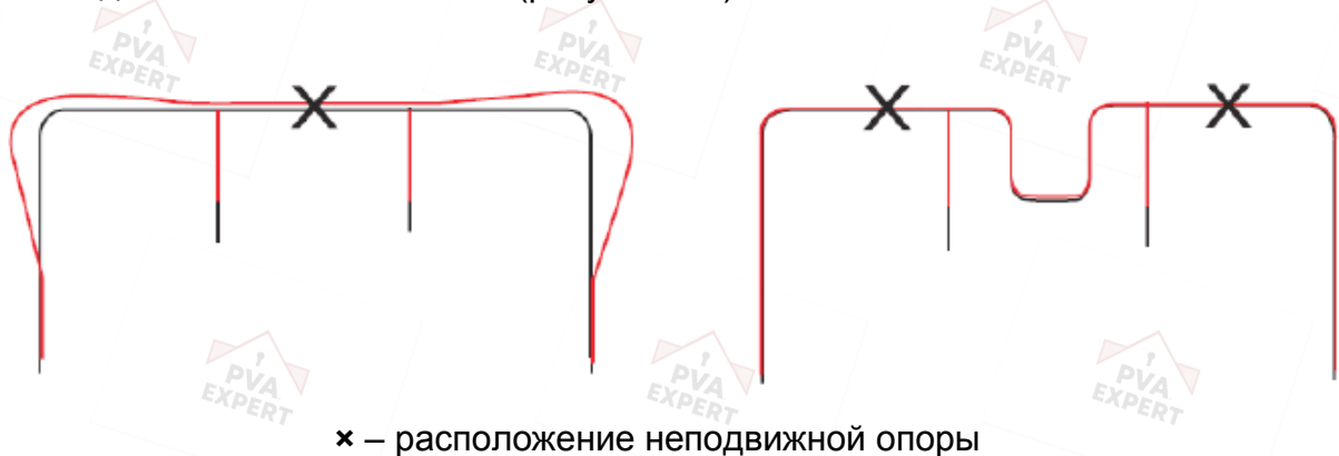
Рисунок А.1 – Корректное расположение неподвижных опор
