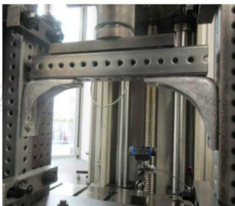
Рисунок И.12 – Примеры испытаний на сдвиг ( а ) и на изгиб ( б )
