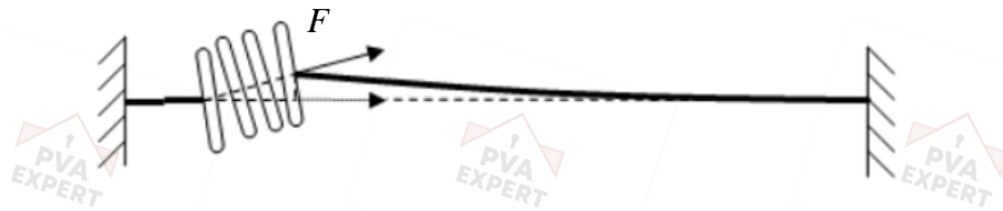
Рисунок А.14 – Нарушение соосности под воздействием боковых усилий
